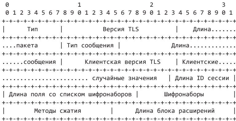
Рис. 9.3. Структура пакета TLS-рукопожатия
