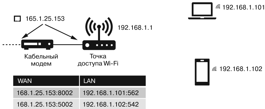
Рис. 8.8. Пример домашней сети, использующей технологию NAT
